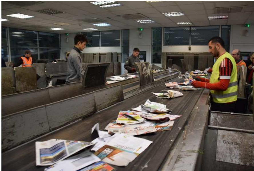
Ultime vérification manuelle avant compactage : il faut avoir le rythme (©Le Réveil normand)
